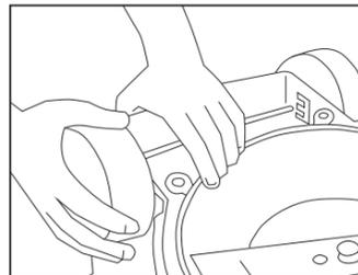
Retirar o plug da tomada e com a lâmina parada, mudar a posição do encaixe das extremidades do eixo, uma de cada vez, fazendo esforço pelas rodas, conforme figura.
